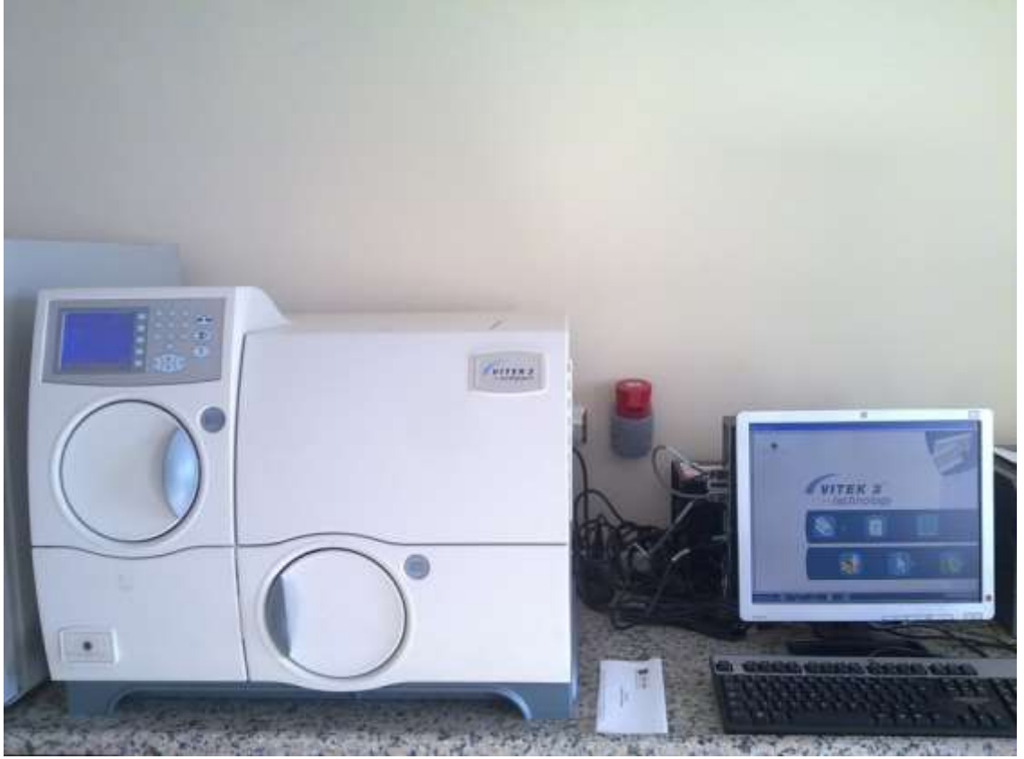
Resim 3.2.2. Çalışmada kullanılan VİTEK 2 Compact ( bioMèrieux, France ) tam otomatik identifikasyon ve duyarlılık sistemi
