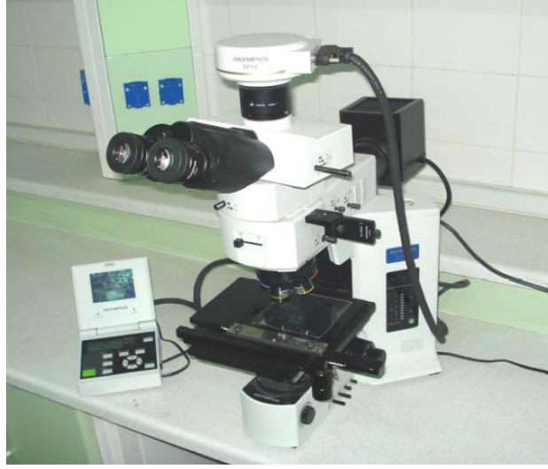
Şekil 3.22. Optik mikroskop ve CCD kameradan oluşan görüntü sistemi [117]
