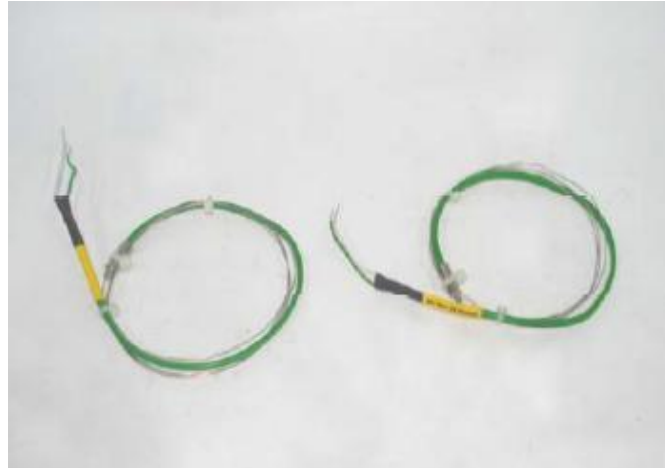
Şekil 3.15. Numunelerin ölçümünde kullanılan R tipi termal çiftler [117]
