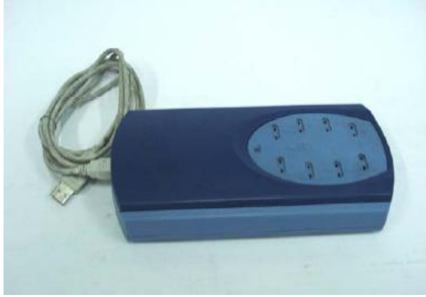
Şekil 3.17. Sıcaklık değişimlerinin kaydedilmesinde kullanılan sıcaklık kaydedicisi [117]
