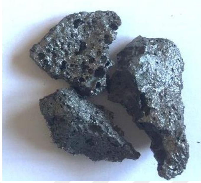
Şekil 4.3. 3 no'lu üretim numunesi (Bacatozu/borikasit karışım oranı 1/8)
