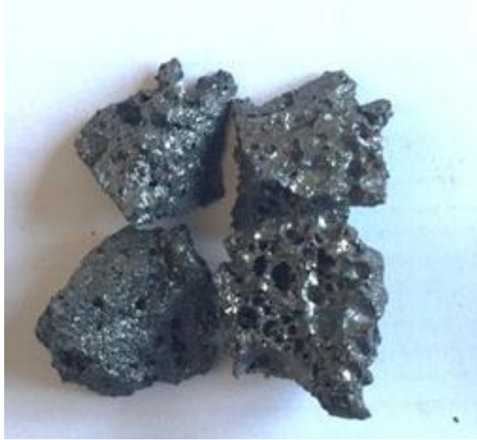
Şekil 4.2. 2 no'lu üretim numunesi (Bacatozu/borikasit karışım oranı 1/4)
