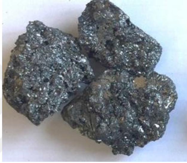
Şekil 4.1. 1 no'lu üretim numunesi (Bacatozu/borikasit karışım oranı 1/2)
