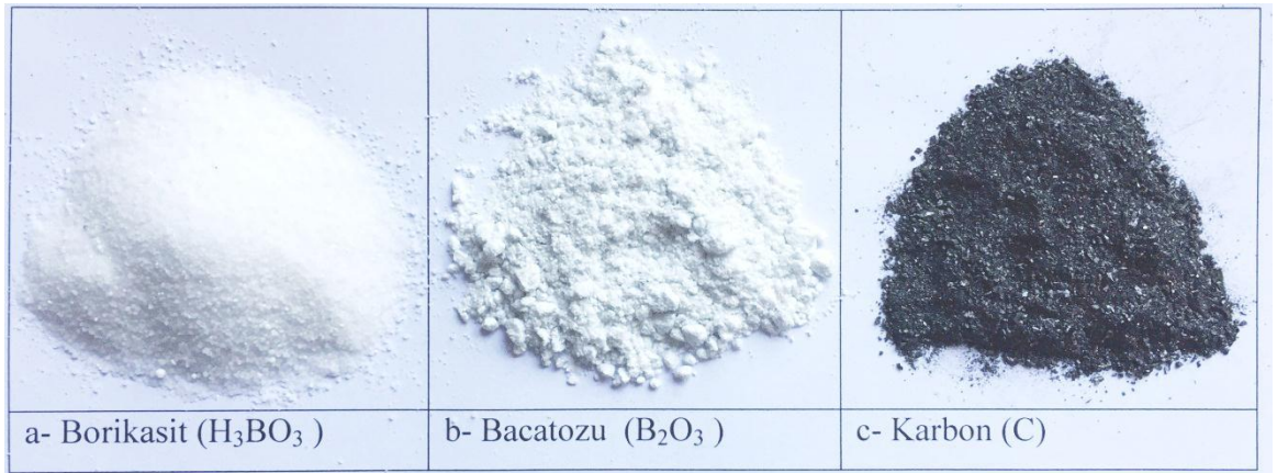
Şekil 3.3. B_4C üretimi için kullanılan hammaddeler
