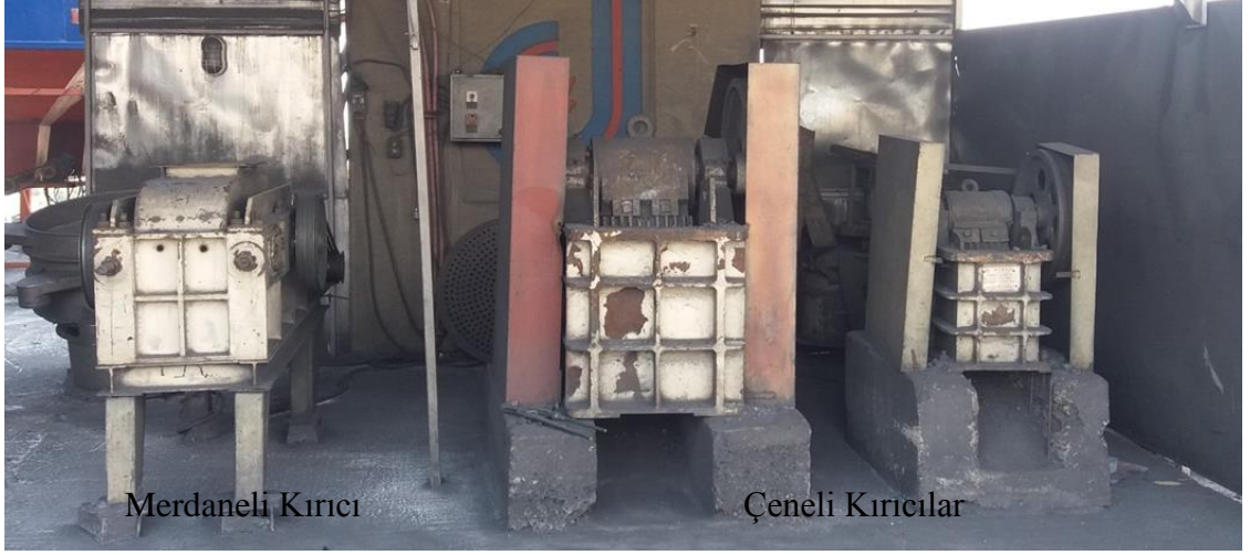
Şekil 3.8. B 4 C Kütüğü Kaba ve İnce Kırma İşlemleri İçin Kullanılan Kırıcılar
