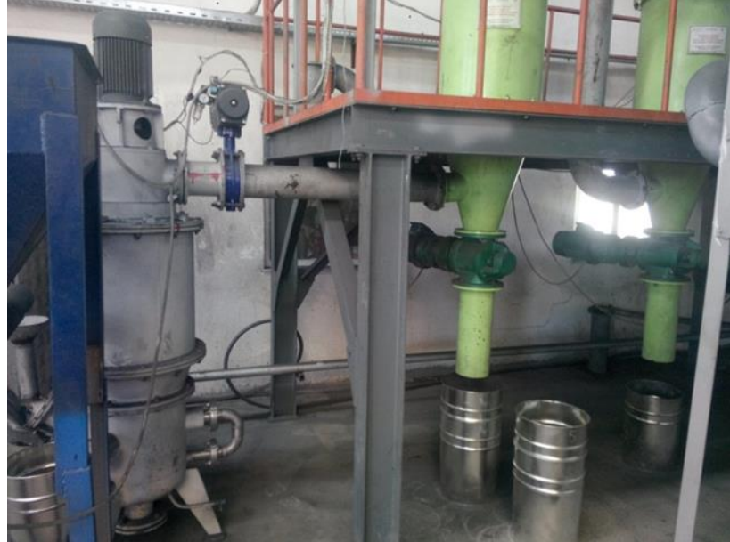
Şekil 3.9. (Jetmill) Havalı Öğütücü Sistemi
