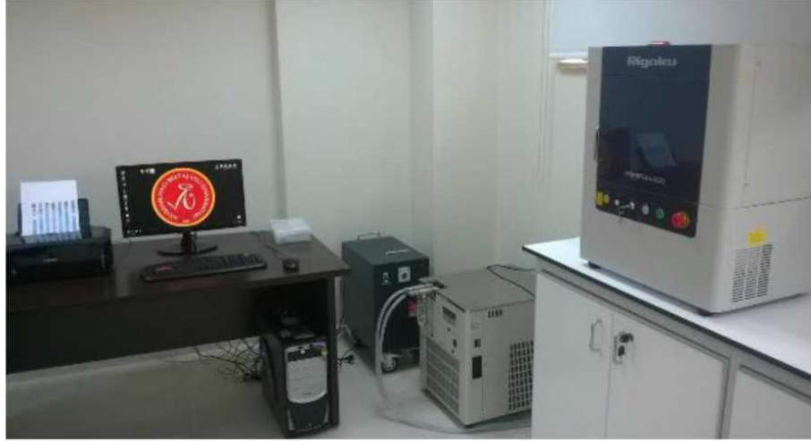
Şekil 3.7. RIGAKU MINIFLEX 600 model XRD cihazı
