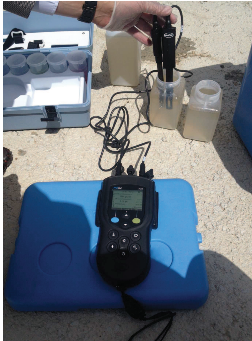
Resim 3.5 Atıksu kanal çıkışının pH ve sıcaklık ölçümü
