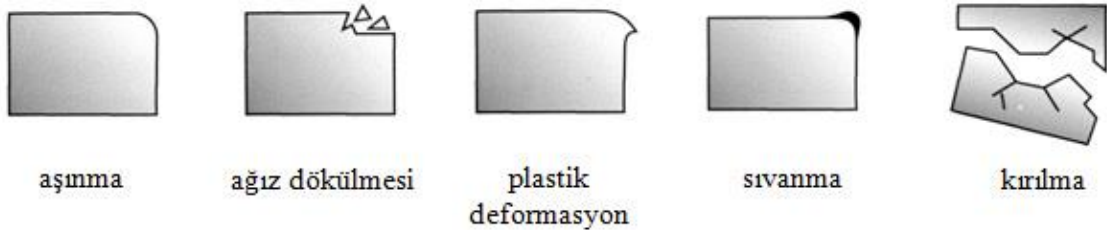
Şekil 3.212 Soğuk iş takım çeliklerinde en çok karşılaşılan hasar mekanizmaları [23].
