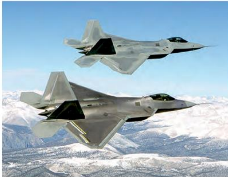
Şekil 2.4 F22-Raptor'un Ağırlıkça %45 i Ti Alaşımlarıdır [7].
