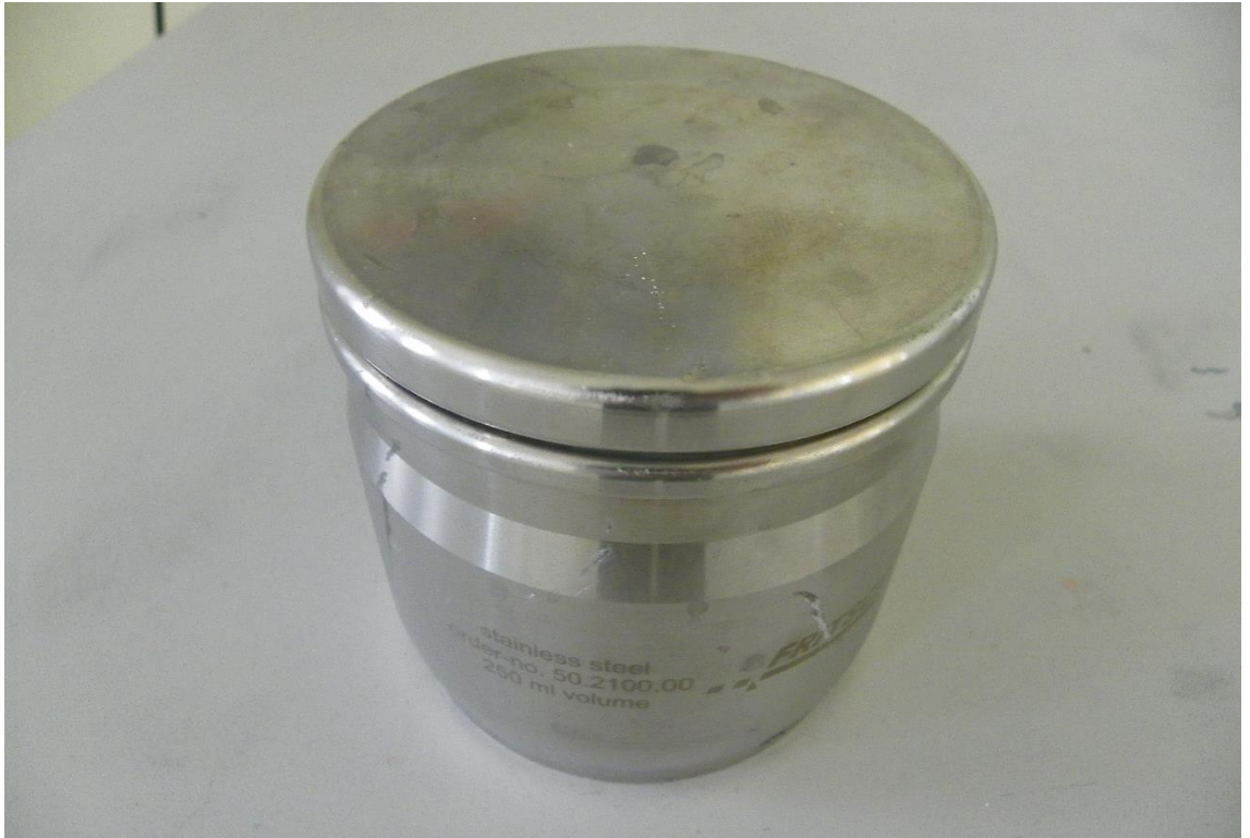
Şekil 5.6 Paslanmaz çelik Fritsch 250ml'lik hazne
