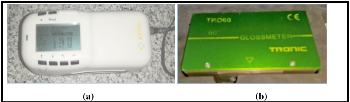
Resim 3.7. a) X-Rite SP62 spektrofotometre b) Tronic TRO60 glossmetre
