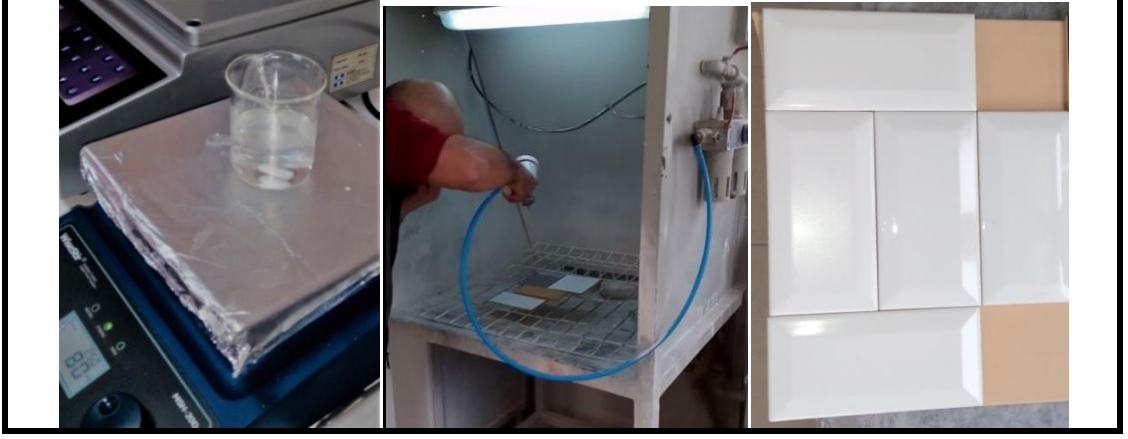
Resim 3.1. Sol hazırlanışı ve uygulanması.
