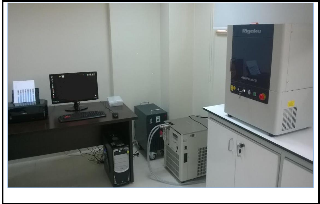
Resim 3.4. Rigaku Miniflex 600 X-ışını Difraktometresi.
