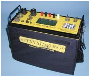
Şekil 3: Elektrik öz direnç ölçüsünde kullanılan çok-kanallı jeofizik cihaz ve ölçüm görüntüsü
