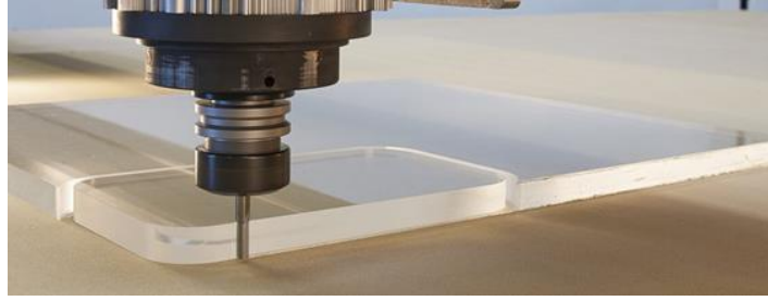
Şekil 5: CNC router makinesinin kesim bıçağı bölümünün çalışma prensibi [3]
