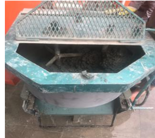
Şekil 2. KYB’yi oluşturan malzemelerin karıştırılması
