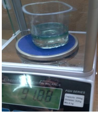
Şekil 2: Epoksi ve sertleştiricinin tartılması.
