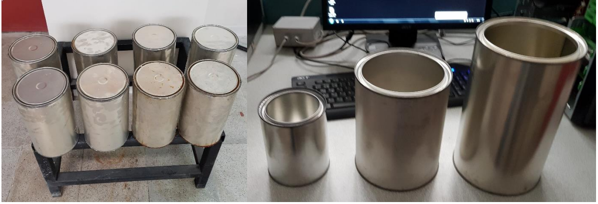
Şekil 7: Parafini tank içerisine yerleştirmek için kullanılan kapsüllerin görünümü
