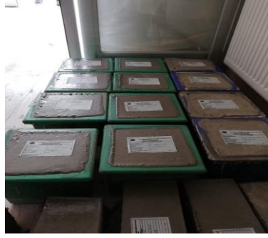
Şekil 3. KYB karışımların kalıba dökülmesi
