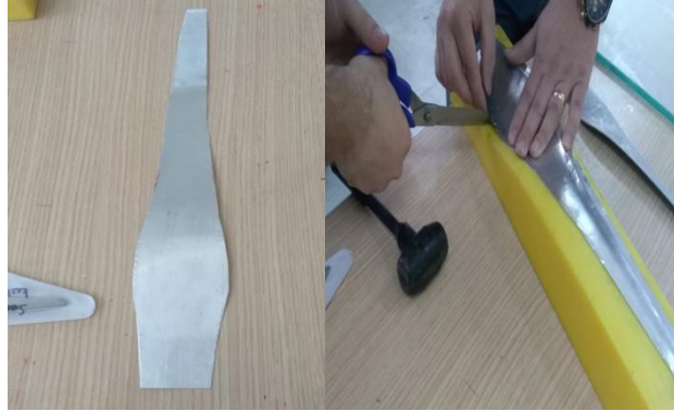
Şekil 3: Kanat formu için kesilmiş alüminyum sac levha ve kalıba yerleştirilmesi
