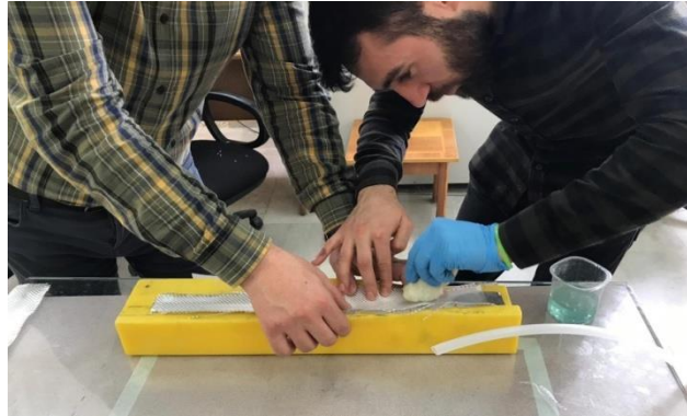
Şekil 6: Cam elyaf kumaşların yerleştirilmesi ve Epoksi reçinenin sürülmesi.
