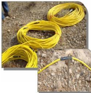
Şekil 3: Elektrik öz direnç ölçüsünde kullanılan çok-kanallı jeofizik cihaz ve ölçüm görüntüsü
