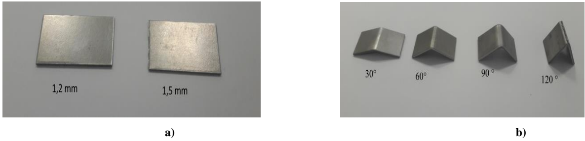
Şekil 2.2 Deneysel Çalışma Malzemeleri a) Bükme İşlemi Öncesi b) Bükme İşlemi Sonrası
