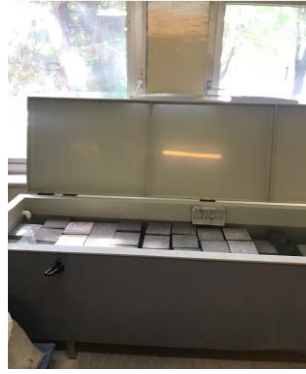
Şekil 4. KYB numunelerinin kür havuzuna alınması
