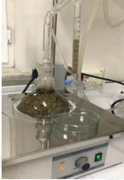
Resim 4.3 Düzeneğin çalıştırılması ve uçucu yağın üst tarafta birikmesi
