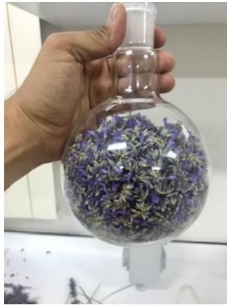
Resim 4.2 Lavanta çiçeklerinin saplardan ayrılarak balon jöjeye alınması
