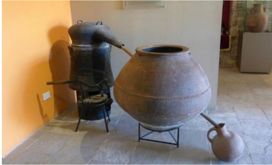
Fotoğraf 3: Zivaniya Çıkarmak İçin Kullanılan Damıtma Sistemi
