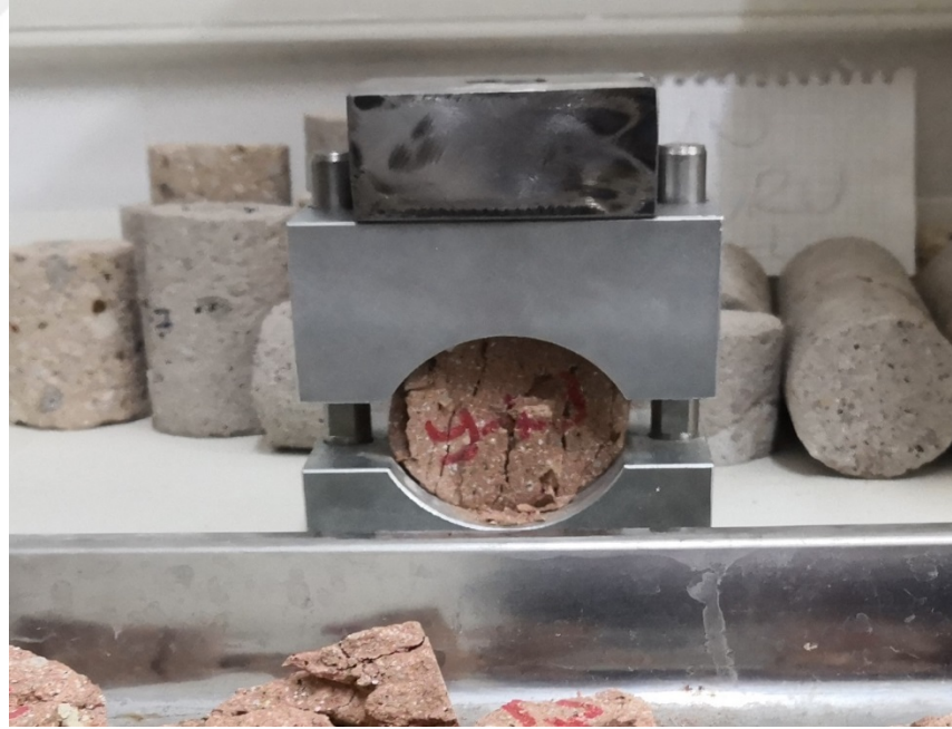
Resim 3.3. Çekme dayanımı deneyinin uygulanması
