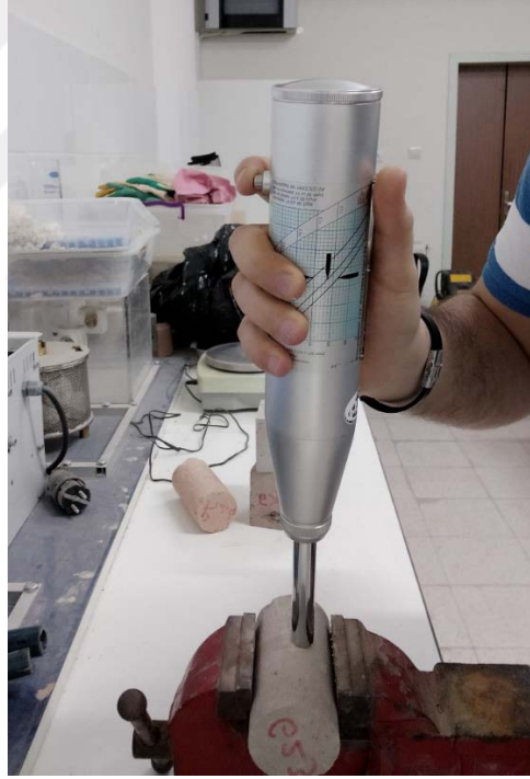
Resim 1.1. Schmidt çekicinin laboratuvarında silindirik örnek üzerinde uygulanması
