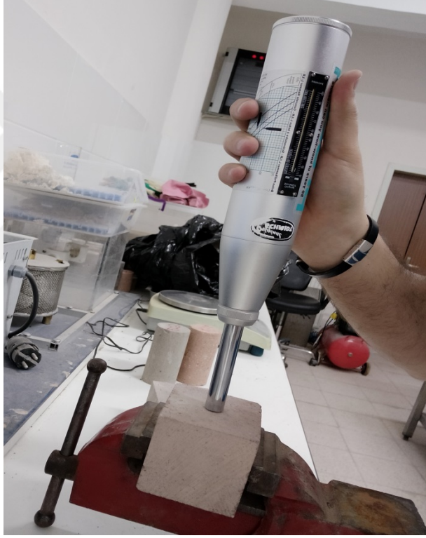
Resim 3.4. Schmidt çekicinin laboratuvarında küp örnek üzerinde uygulanması
