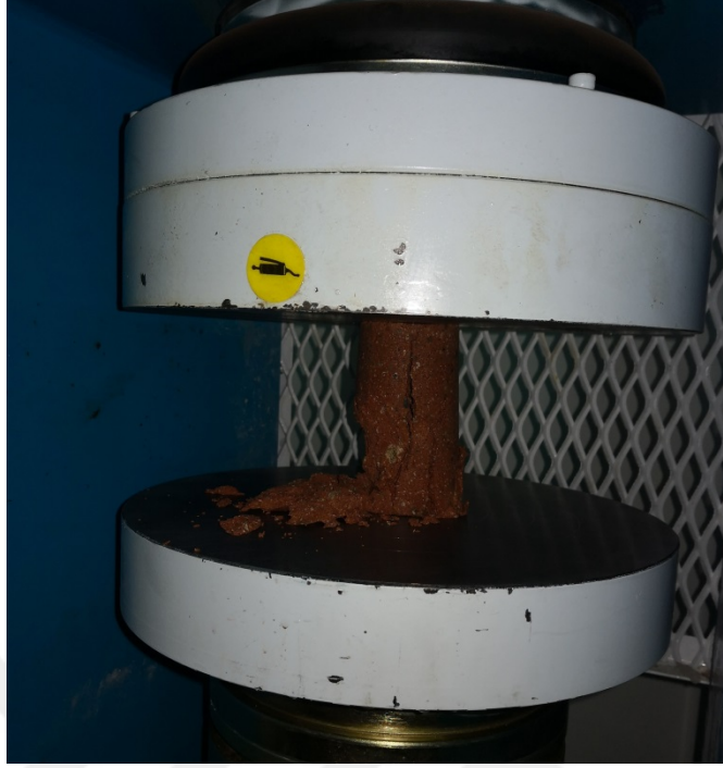
Resim 3.2. Tek eksenli basınç dayanımı deneyinin uygulanması
