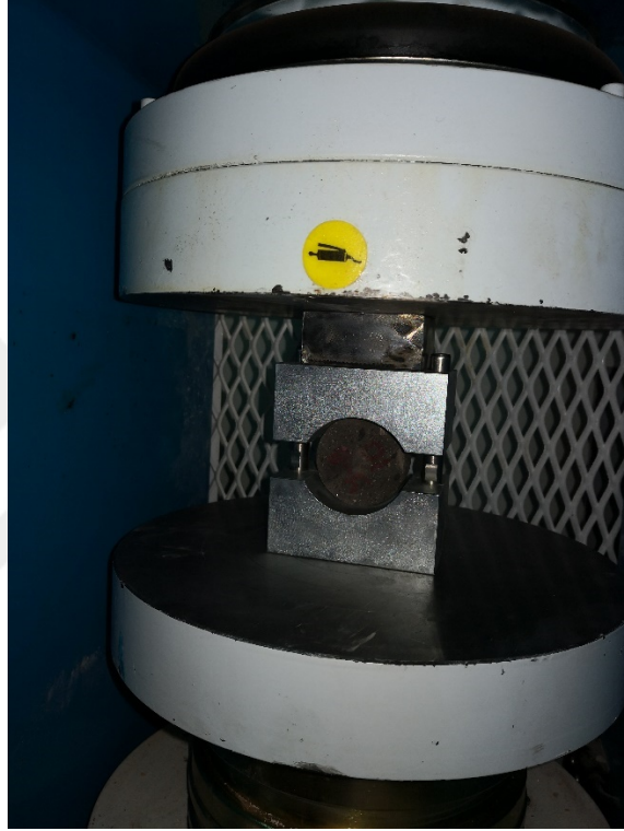
Şekil 5.5. Laboratuvarında gerçekleştirilen dolaylı çekme dayanımı deneyinden bir görünüm
