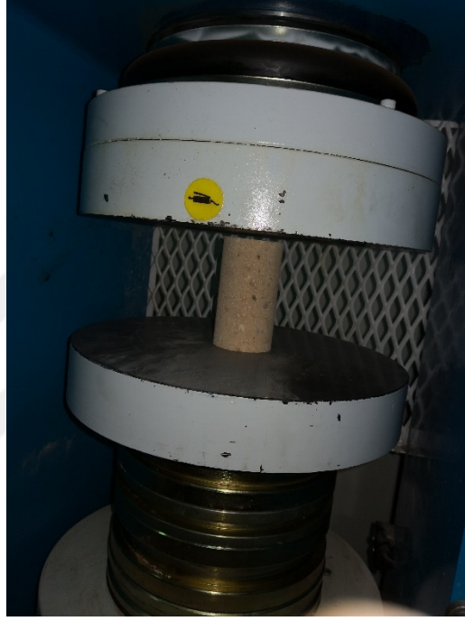
Şekil 5.6. Laboratuvarda gerçekleştirilen tek eksenli basınç dayanımı deneyinden bir görünüm
