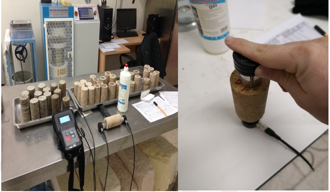
Şekil 2.2. P-dalga hızı ölçüm düzeneği ve deneyden bir görünüm
