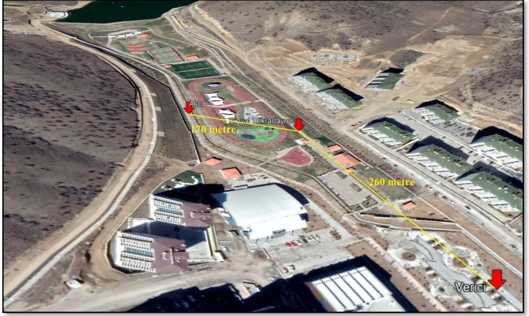
Şekil 5.18. İmal edilen yönlü mikroşerit anten ile nLOS dış mekan ölçüm planı
