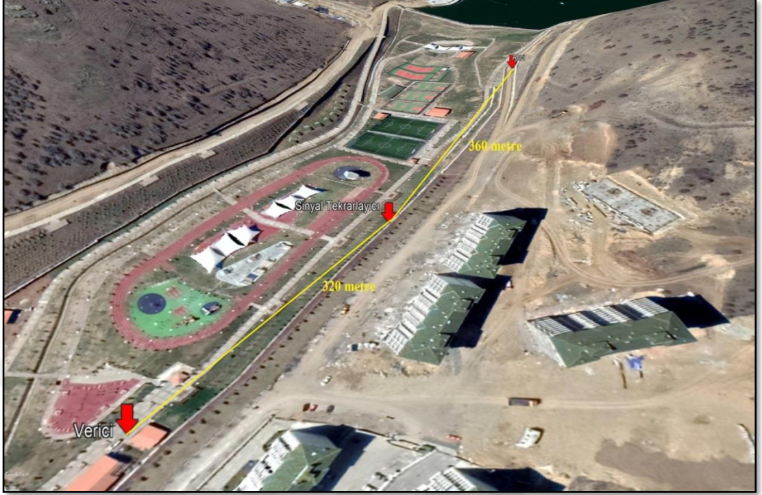
Şekil 5.12. İmal edilen monopol Yagi-Uda anteni ile LOS dış mekan ölçüm planı
