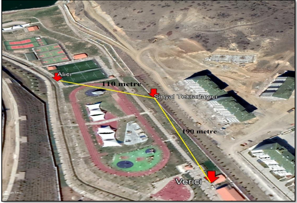
Şekil 5.13. İmal edilen monopol Yagi-Uda anteni ile LOS dış mekan ölçüm planı
