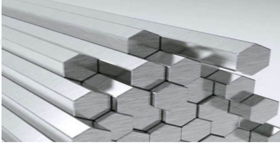
Şekil 2.3 Altıgen Kesitli Üretilmiş AISI 8620 Çeliği
