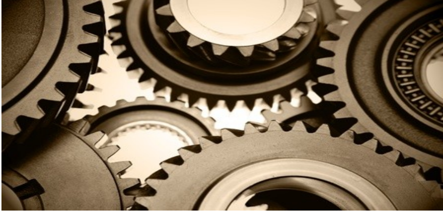
Şekil 2.4 AISI 8620 Çeliğinin Dişli Çarklarda Kullanımı
