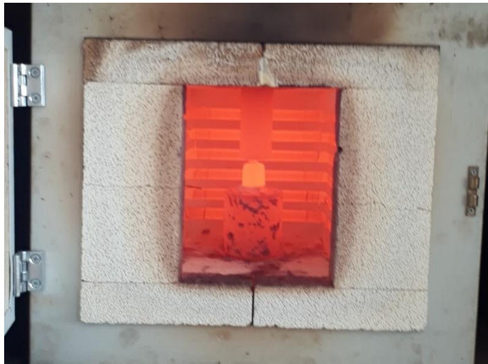
Şekil 3.4 Difüzyon Kaynak Numunesinin Sıcaklık ve Yük Altındaki Durumu
