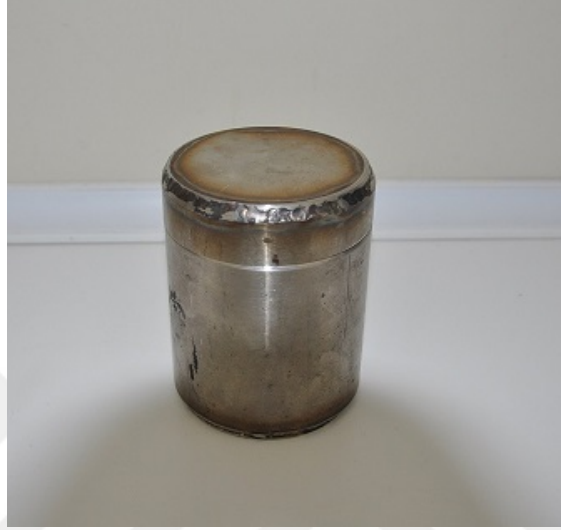
Şekil 12. Tuz Banyosunda TRD Yönteminde Kullanılacak Paslanmaz Çelik Pota
