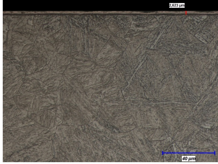
Şekil 27. 1000 °C’de 2 saat süre ile gerçekleştirilen VC kaplama optik mikroyapı fotoğrafı
