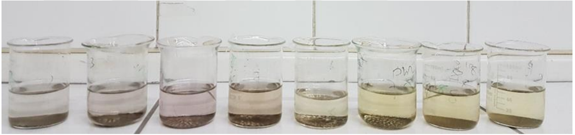
Resim 4.1. Fenton reaksiyonları sonrası çökelme
