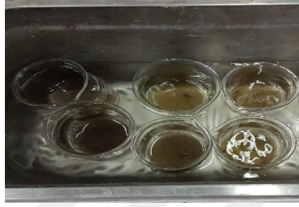
Resim 3. 2. Ultrasonik su banyosu Fenton Taşlama tozu çözme
