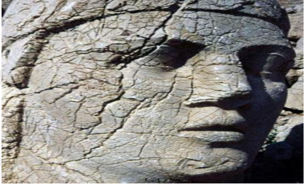
Şekil 5. 13 Kireçtaşından yapılmış Apollon Heykeli üzerinde mikrokarst oluşumu [43]
