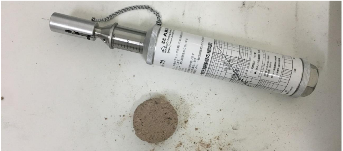
Şekil 3. 4 Tez çalışmasında kullanılan iğne penetrometresi aleti
