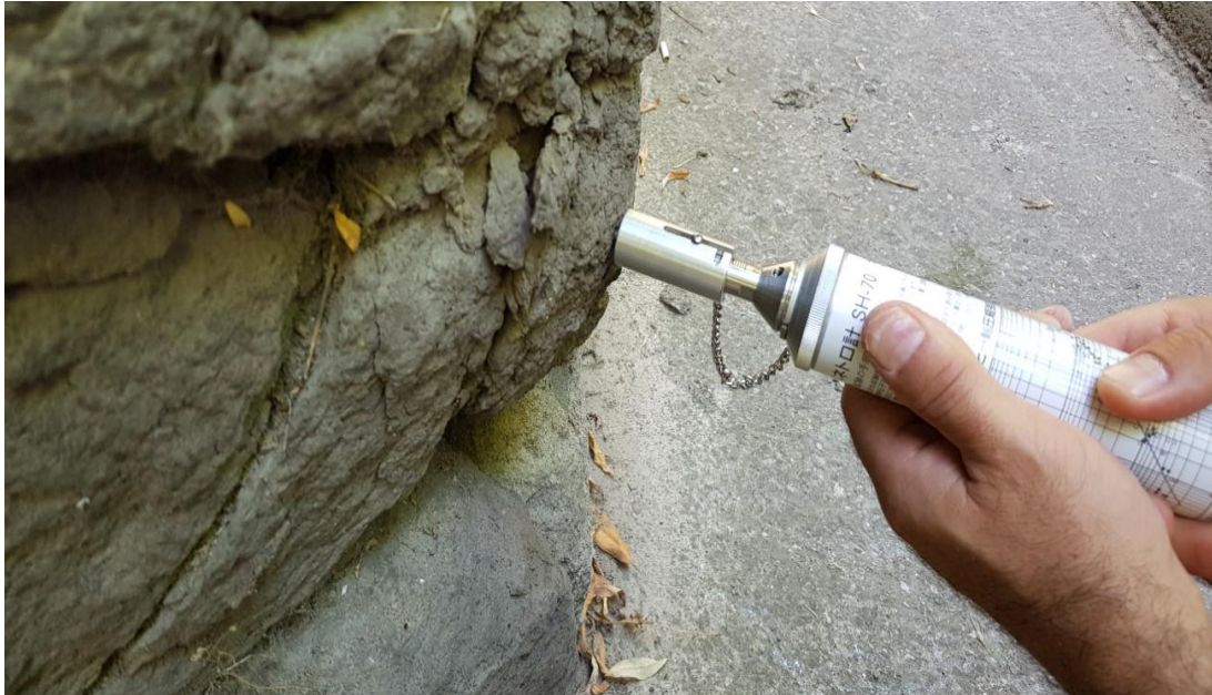
Şekil 3. 5 Tarihi eserlerde gerçekleştirilen İğne penetrometresi deneyinden bir görünüm
