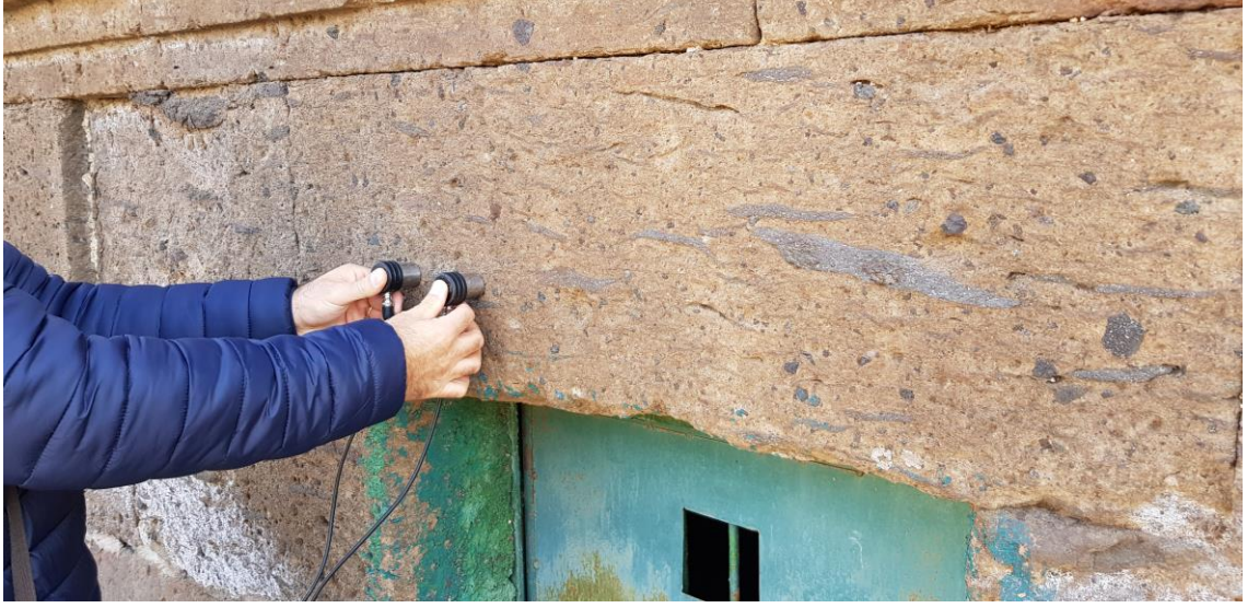
Şekil 3. 1 Bu tez çalışması kapsamında tarihi eserlerde gerçekleştirilen P-dalga hızı ölçümünden bir görünüm
