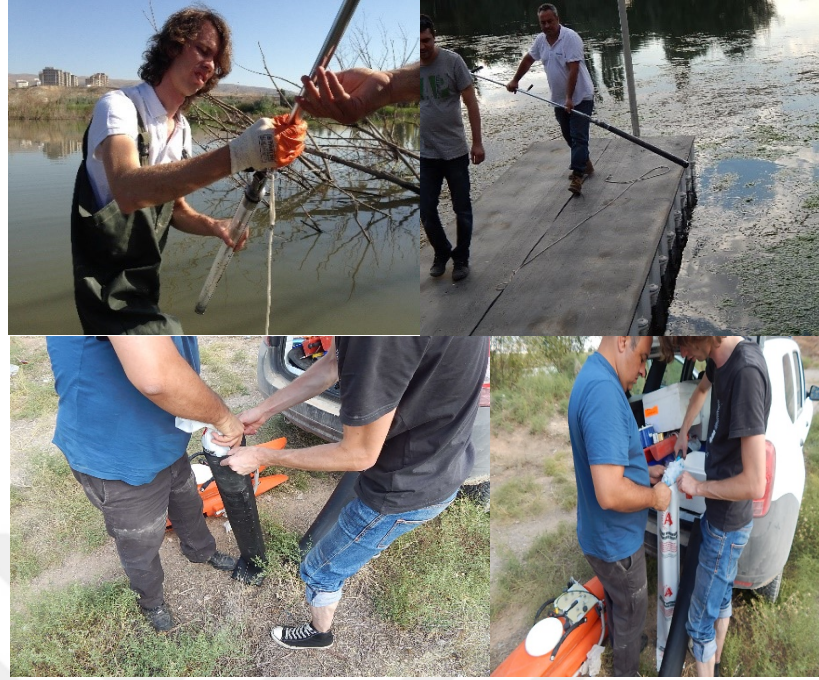
Resim 2.10. Saha Çalışmalarında Kızılırmak Nehir Tabanından Sediment Karot Örneklerinin Alınması [26]
