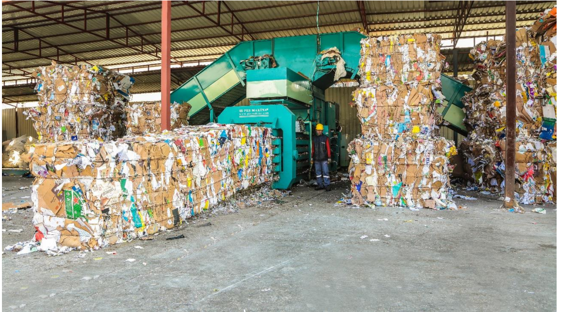
Resim 4.10. Ayrıştırılan malzemelerin preslenip balya hali
