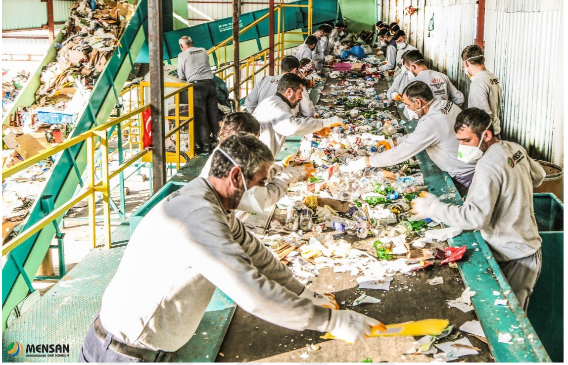
Resim 4.9. Sisteme giren ambalaj atıklarının ayrıştırılması işlemi
