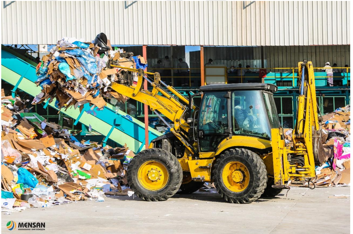
Resim 4.8. Ayırma sistemine besleme yapan beko-loder
