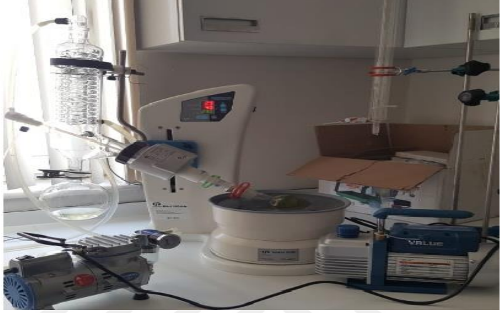
Resim 3.3. Bitki özütünden metanolü uzaklaştıran evaporasyon işlemi
