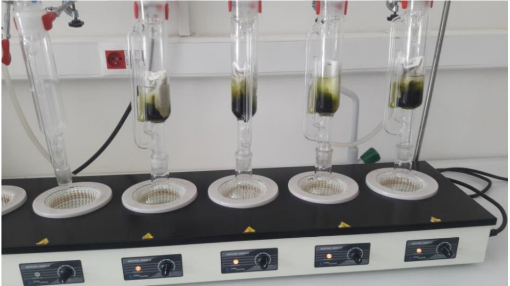
Resim 3.2. Bitki özütü eldesi için kullanılan soxhlet ekstraksiyon cihazı
