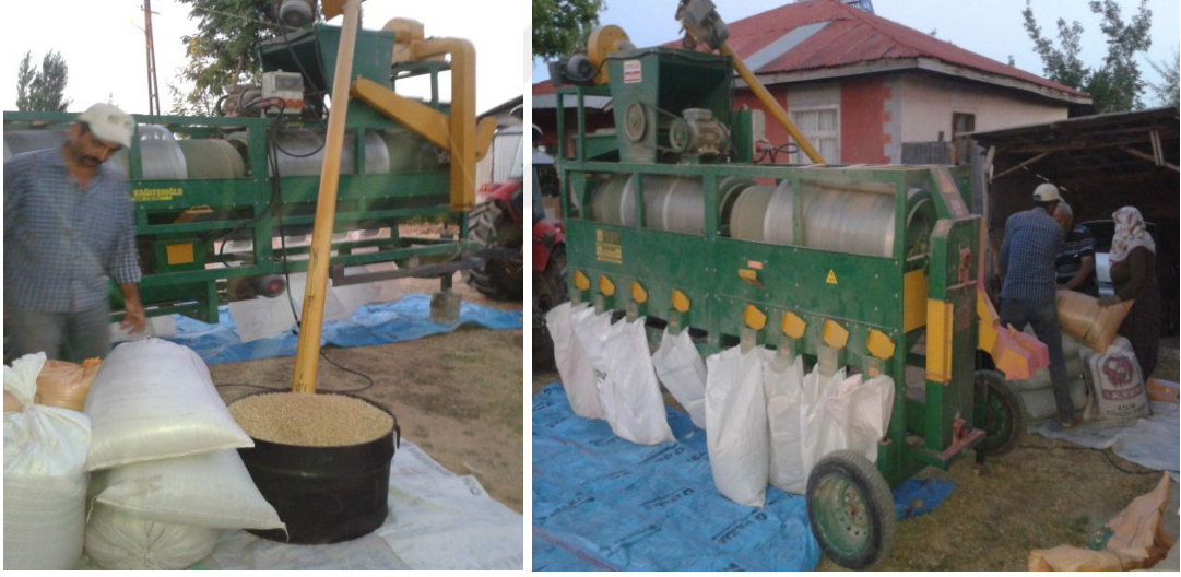
Foto 2.7. Cumhuriyet Mahallesinde Elektrikli, Büyük Eleme Makinası ile Elenen Buğdaylar.
