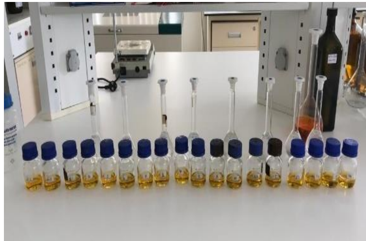
Resim 3.1 Kapalı reflüks yöntemi ile KOİ ölçümü
