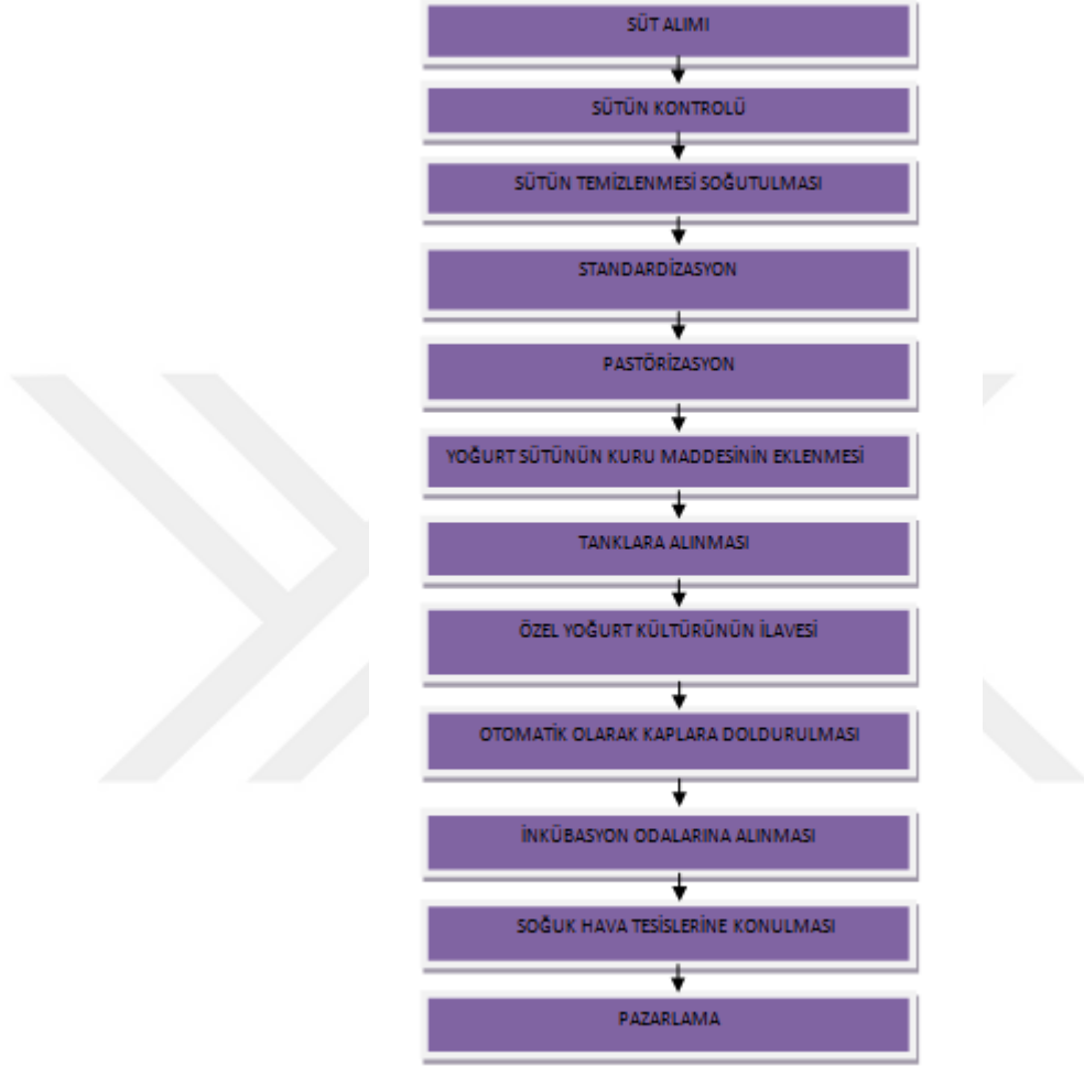
Şekil 2.6 Yoğurt Üretim Aşamaları
