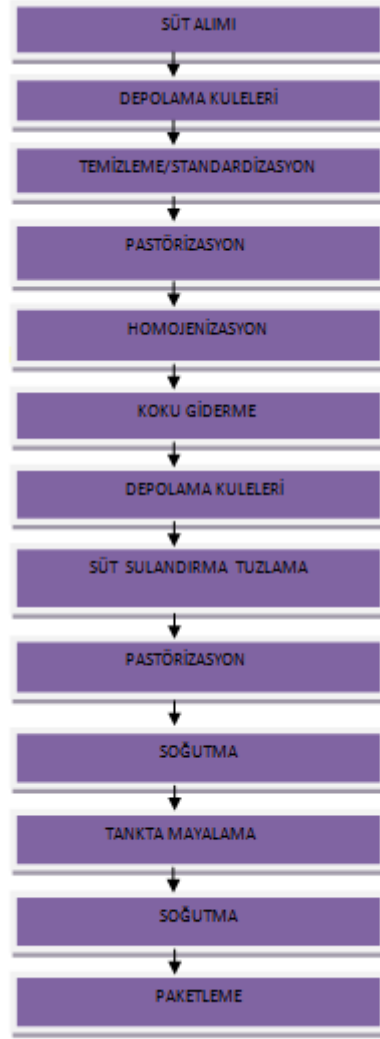
Şekil 2.7 Ayran Üretim Aşamaları
