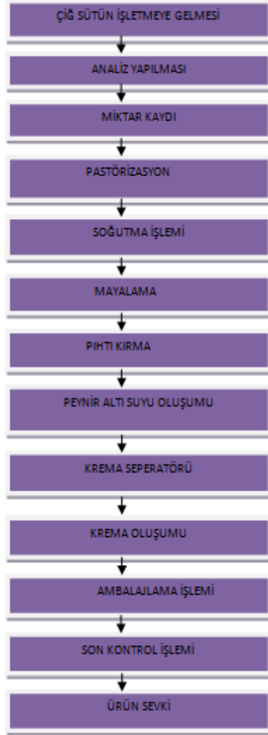
Şekil 2.5 Krema Üretim Aşamaları
