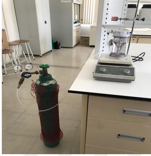
Resim 3.4 Azot gazı ile pozitif basınçlı ve karıştırmalı süzme düzeneği
