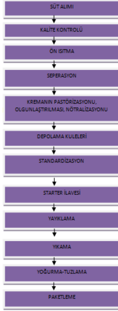
Şekil 2.8 Tereyağı Üretim Aşamaları
