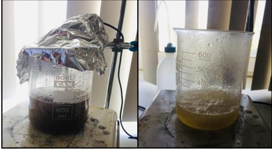
Resim 3.21 0,05 M \text{FeSO}_4 \cdot 7\text{H}_2\text{O} yardımıyla peroksit ile ıslak oksidasyon işlemi
