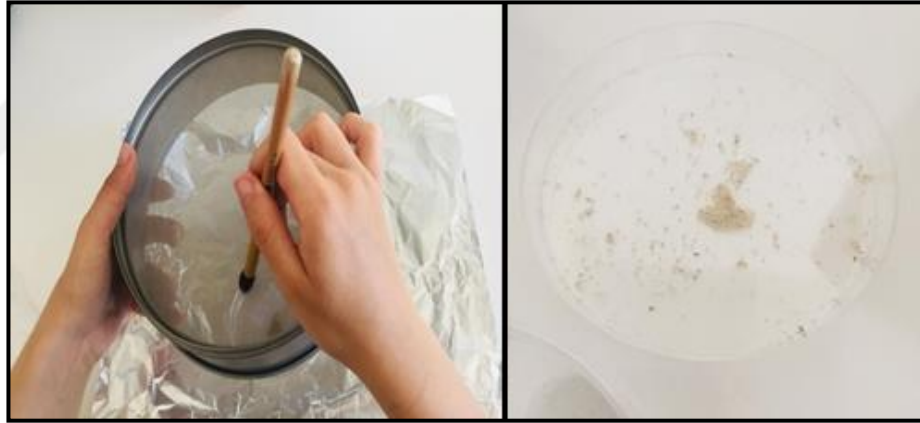
Resim 3.24 Katı parçacıkları petri kabına alma işlemi
