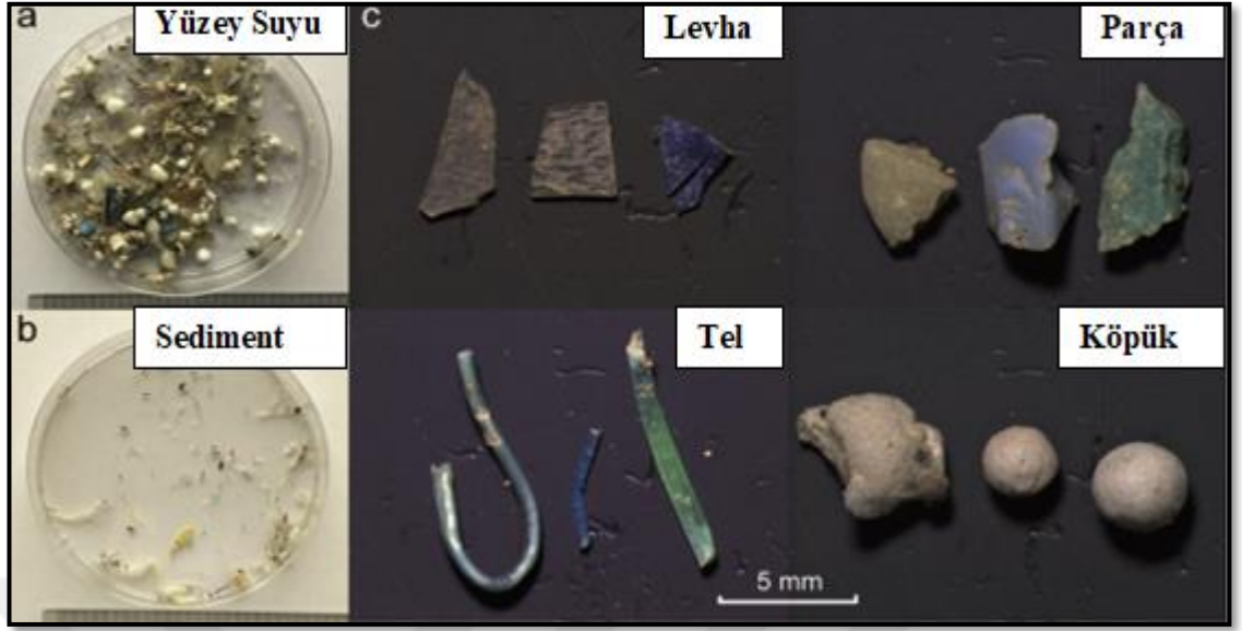
Şekil 2.2 a) Yüzey sularında bulunan tipik mikroplastikler ve b) tortu (sediment) numuneleri; c) mikroplastiklerin morfolojisi [23]
