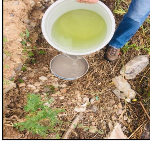
Resim 3.17 Numuneleri elekten süzme işlemi
