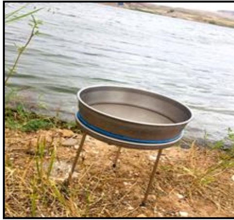
Resim 3.16 Numune alınımında sahada kullanılan 200 µm gözenek çaplı çelik elek
