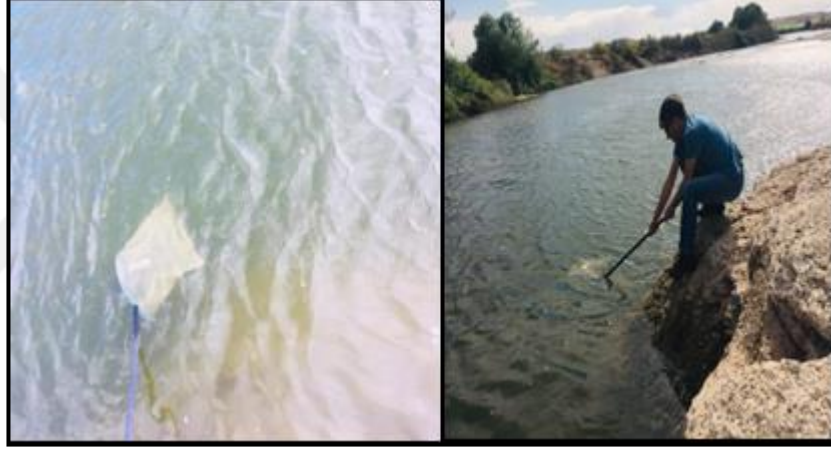
Resim 3.18 Nehirden kepçeyle numune alınması
