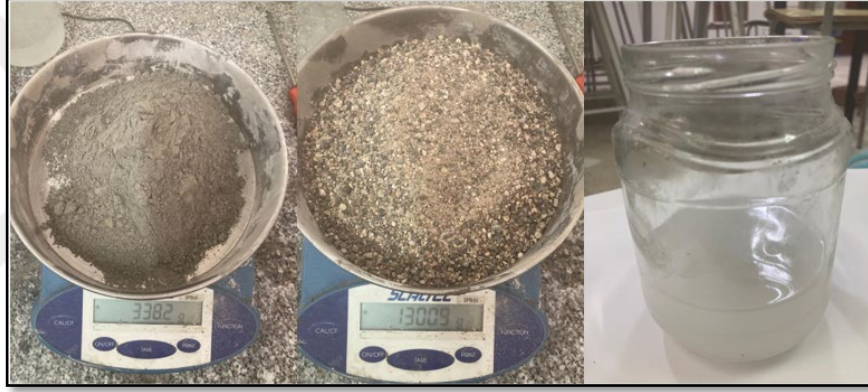
Resim 5.5. Geopolimer harç üretimi için malzeme hazırlıkları.
