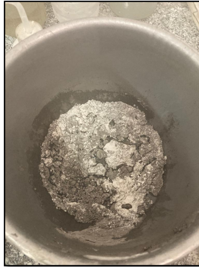
Resim 5.6. Perlit, uçucu kül ve aktivatörün mikser kabında görünümü.
