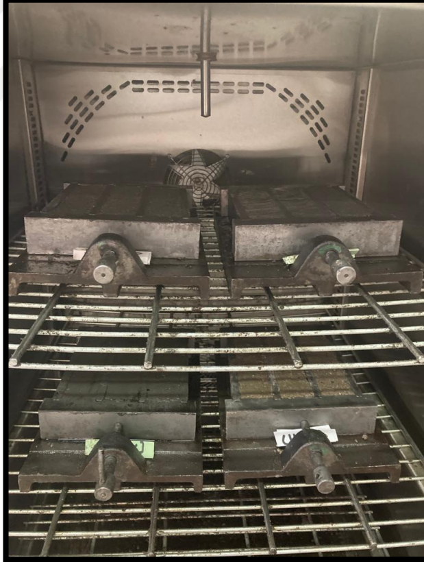
Resim 5.8. Geopolimer harçların kür fırınındaki görünümü.
