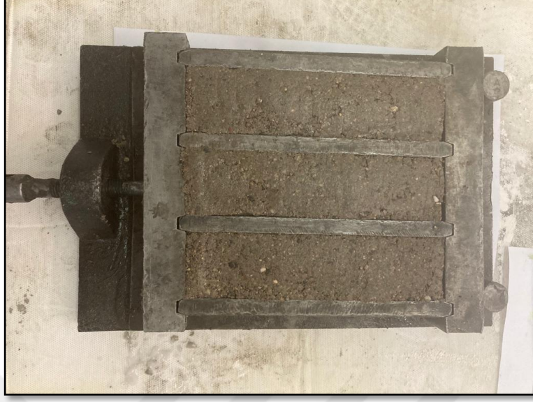
Resim 5.7. HP50UK50-4 kodlu karışımın harç kalıbında taze haldeki görünümü.
