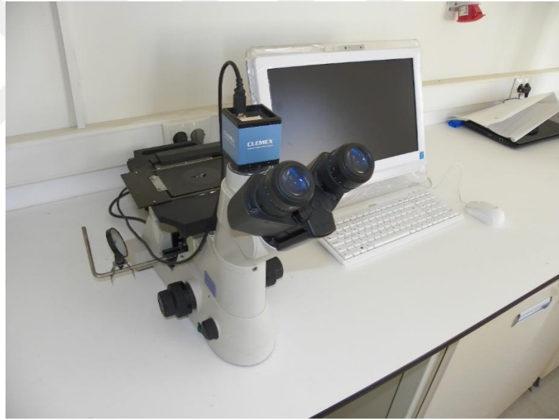
Şekil 4.6. Nikon MA 100 Ters Metal mikroskobu
