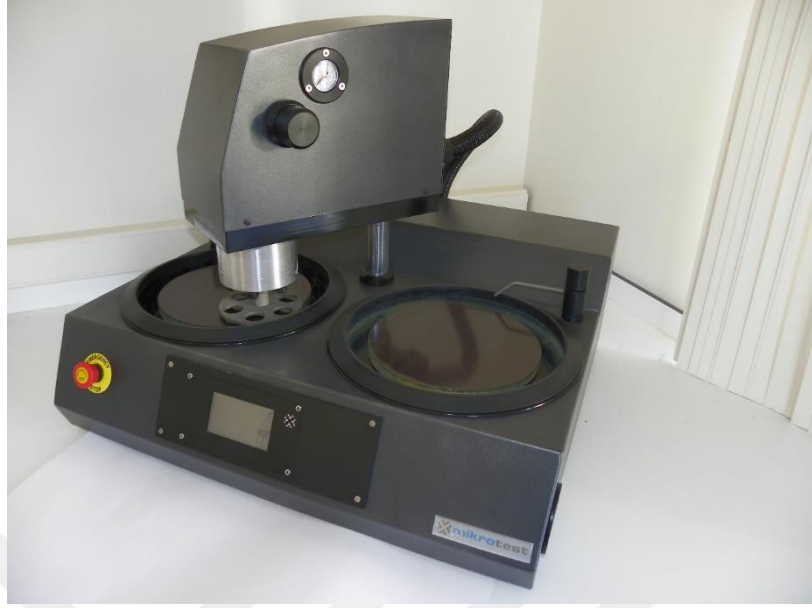
Şekil 4.5. Mikrotest yarı otomatik zımparalama ve parlatma cihazı
