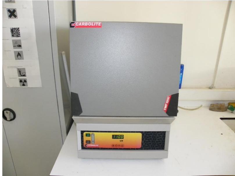
Şekil 4.2. Yüksek sıcaklık fırını
