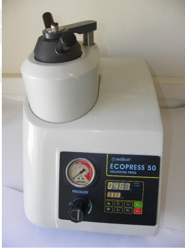
Şekil 4.4. Metkon Ecompress 50 sıcak bakalit kalıplama
