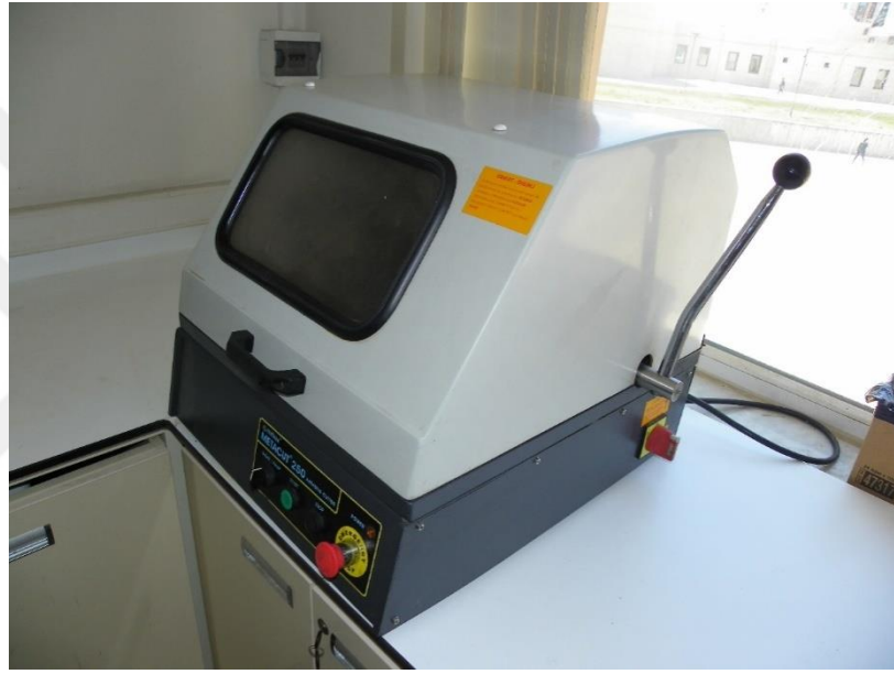
Şekil 4.3. Hassas numune kesme cihazı
