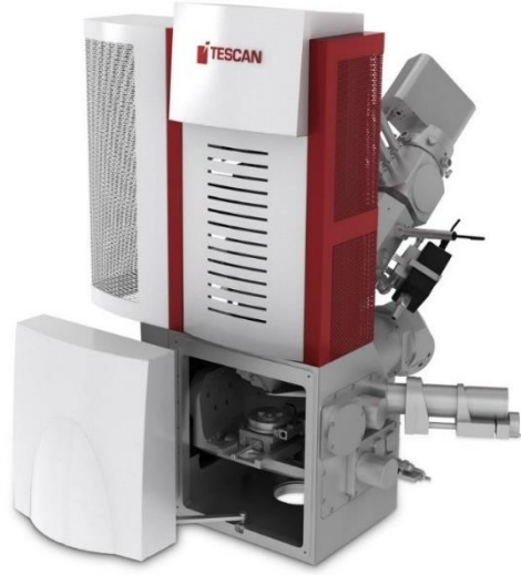
Şekil 4.7. Tescan MAIA3 XMU Elektron mikroskobu (SEM).
