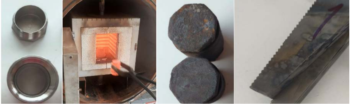
Şekil 3.2 Termokimyasal yöntem ile borlama işlemi süreci
