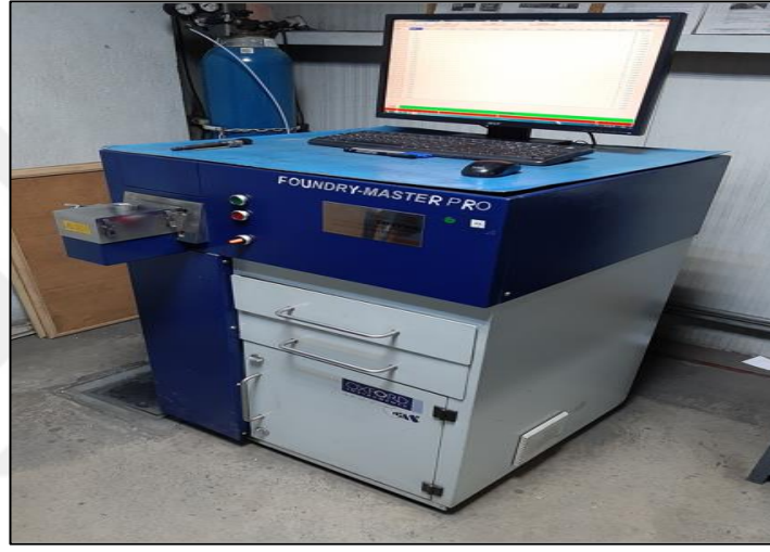
Şekil 3.3. Oxford Foundry Master Pro optik emisyon spektrometresi
