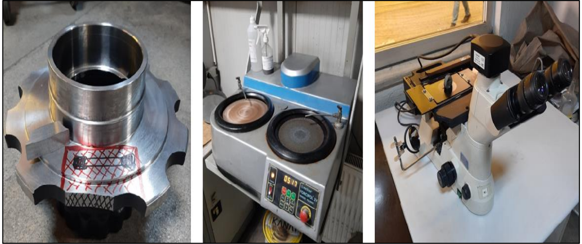
Şekil 3.12. Poryadan mikroyapı, çekme testi, sertlik testi için numune alınan bölge, zımparalama ve parlatma cihazı, MA100 NİKON mikroskop
