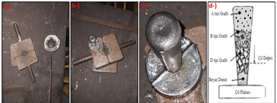
Şekil 3.2. a - Bakır çil numunesi kalıbı ve grafit numune alma kepeçesi, b - çil numunesi, c - çil numunesinin yakın görseli, d - çil numunesi mikroyapı görseli
