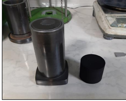
Şekil 3.5. 50x50 mm ebatlarında yağ kum testleri için hazırlanmış numune
