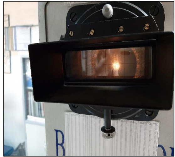
Şekil 3.13. BMS-3000-OB brinell sertlik ölçüm cihazı
