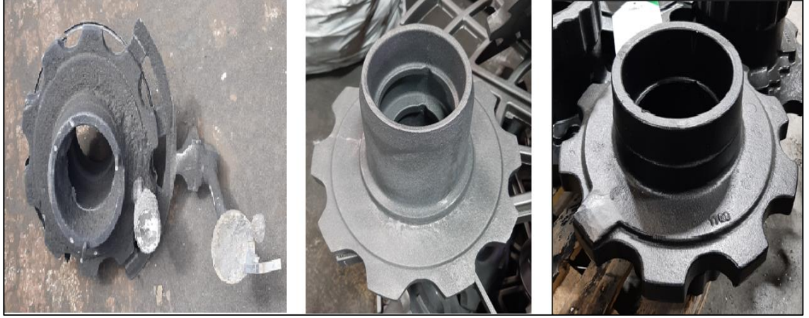
Şekil 3.9. Kum kalıptan çıkmış porya, kumlama sonrası taşlanmış porya, boyama sonrası porya
