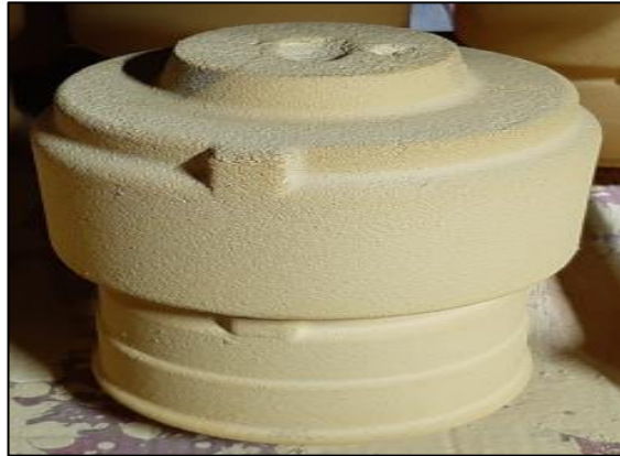
Şekil 3.7. Silis kumundan yapılmış porya maçası
