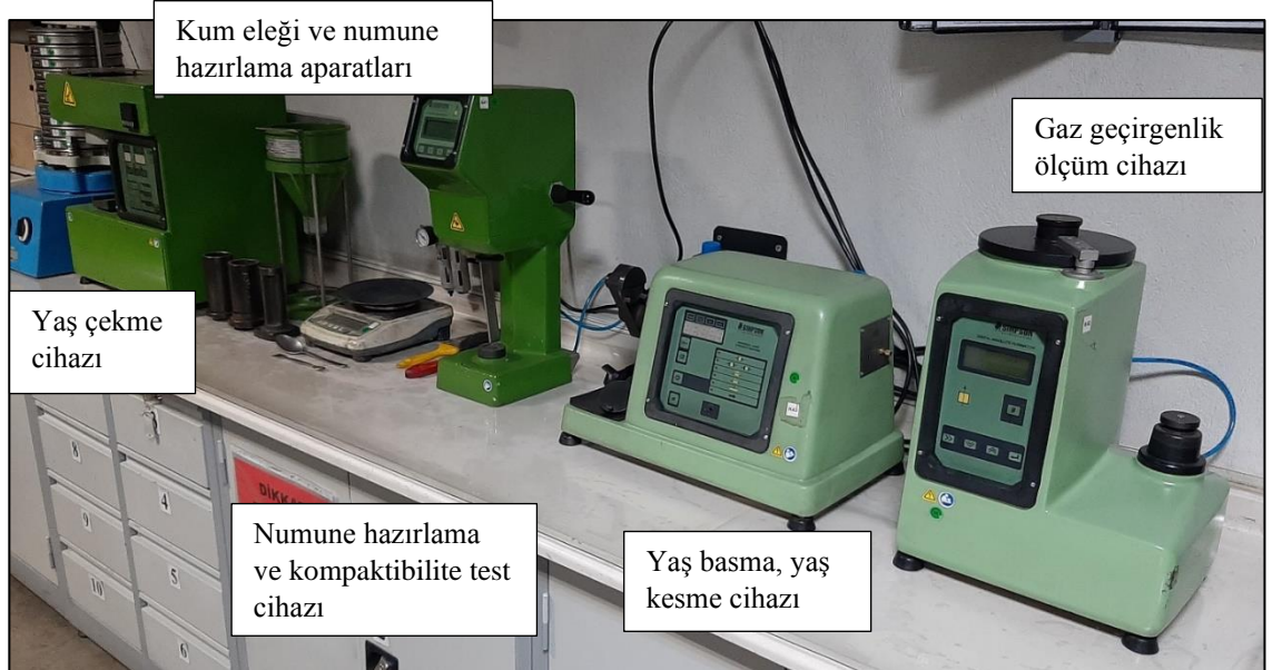
Şekil 3.6. Simpson marka yağ kalıplama kumu test cihazları
