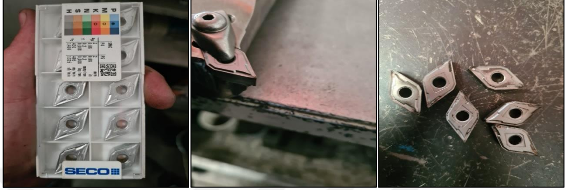
Şekil 4.8. SECO marka, dökme demir ile uyumlu işleme uçları
