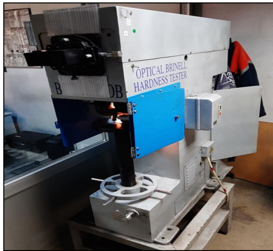
Şekil 3.13. BMS-3000-OB brinell sertlik ölçüm cihazı
